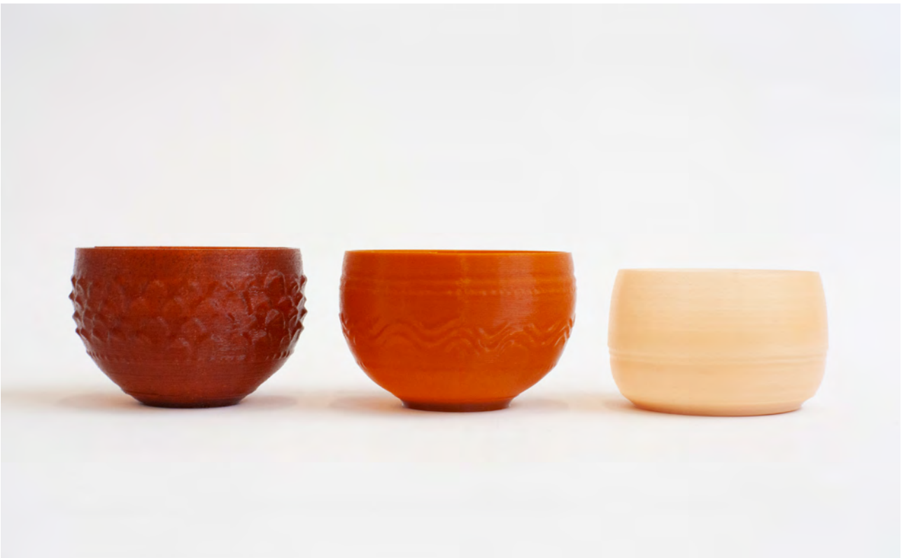
Atelier Luma et le Studio Klarenbeek & Dros, réceptifs imprimés en 3D utilisant un biopolymère mélangé avec Dunaliella et Halobacterium, 2019
